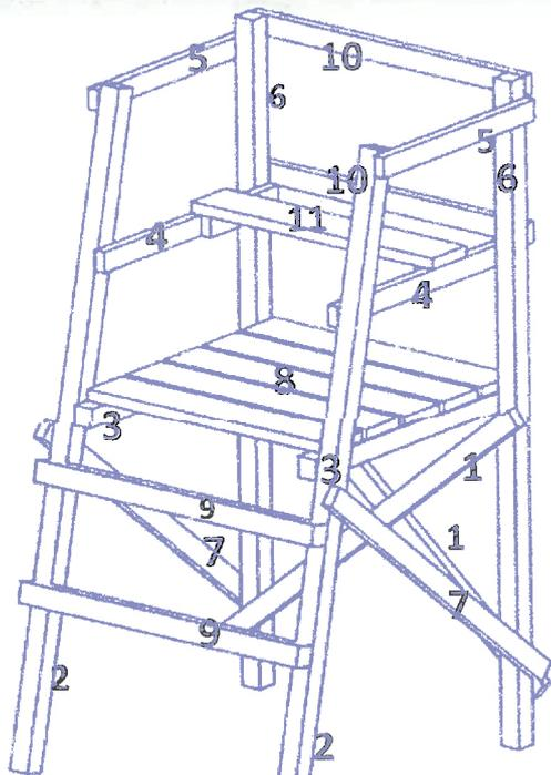
1. Assembler les N° 7, 5, 4 et 3 sur 2 et 6 ainsi que les N°3, 4, 5 et 7 sur 2 et 6 de l'autre côté.
